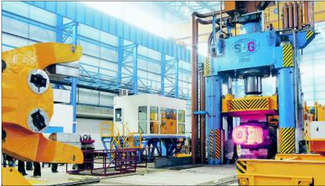
Die neue 4000-Tonnenpresse in der Schmiede der Poldi-Hütte in Kladno.
